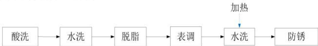
图 4.1-1 江南路 32 号厂区生产工艺流程图
